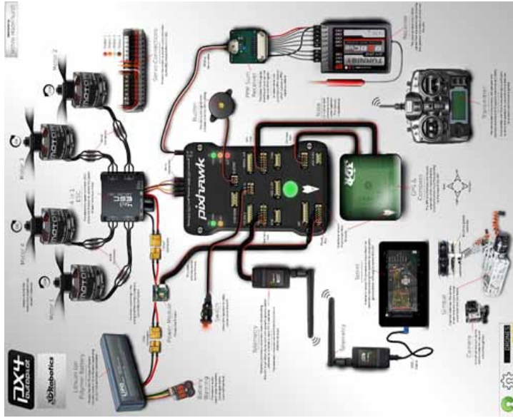
Şekil 7. Pixhawk oto-pilot donanımı ve diğer bileşenler ile bağlantısı. Pixhawk donanımı farklı tip otopilot yazılımları ile kullanılabilir [12].
